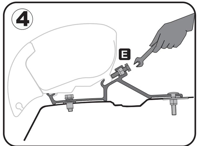
ⒹE **ACHTUNG** Regelmäßig die Befestigung der Halterungen kontrollieren. Achten Sie vor allem nach dem ersten Sicherstellen darauf, dass sich die Haltebügel nicht verschoben haben.
