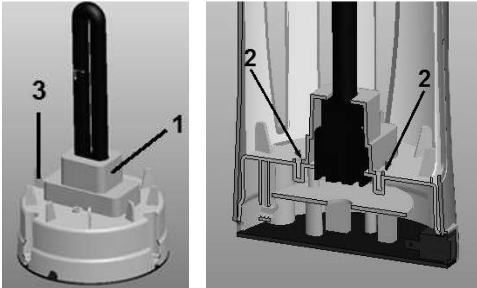
La fixation de la lampe se situe sous le couvercle de protection (1). Ce couvercle est fixé avec 2 vis (2) sur le fond. Pour remplacer la lampe, prenez le couvercle du Glue Trap, desserrez les deux vis avec un tournevis et enlevez le couvercle. A présent, vous pouvez facilement retirer la lampe de la fixation et la remplacer. Enfin, remettez le couvercle en place et fixez-le en le revissant. Utilisez exclusivement une lampe du même type !
