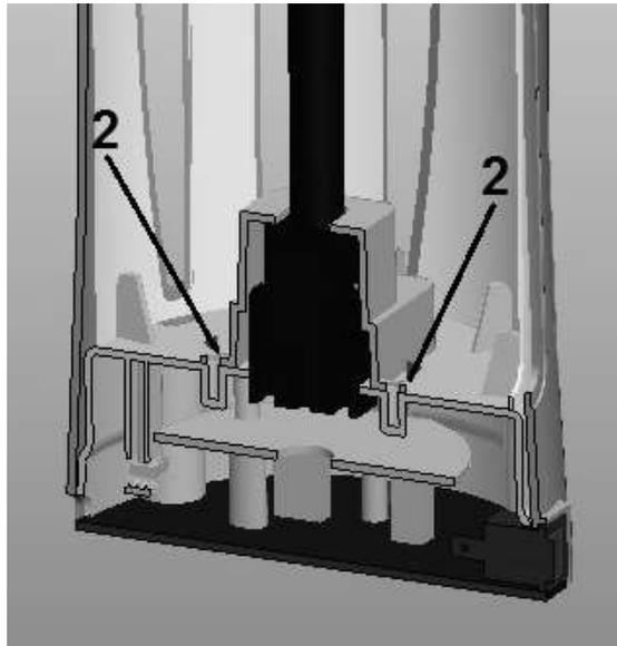
De lampbevestiging zit onder het afdekkapje (1). Dit kapje zit met 2 schroefjes (2) op de bodem bevestigd. Om de lamp te vervangen neemt u het dekseltje van de Glue trap, draait u met een schroevendraaier de beide schroefjes los en verwijdert u het kapje. Nu kunt u de lamp eenvoudig uit de bevestiging trekken en vervangen. Plaats tenslotte het kapje terug en zet het weer vast met de schroefjes. Gebruik uitsluitend een lamp van hetzelfde type!
