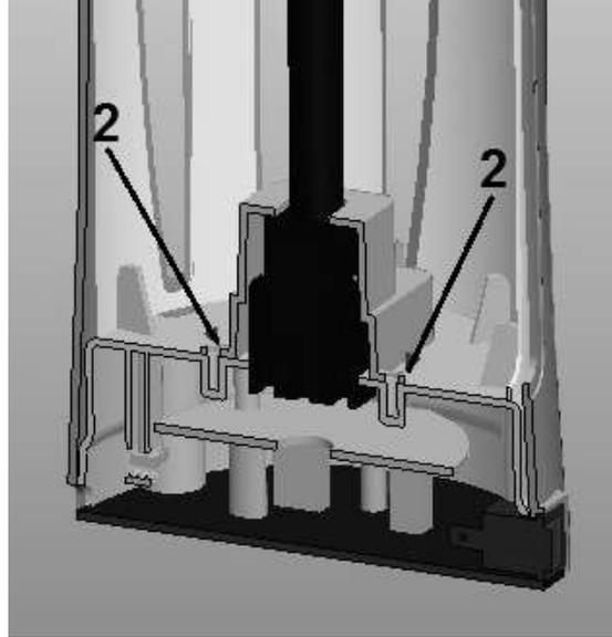
Die Befestigung der Lampe befindet sich unter der Abdeckkappe (1). Diese Kappe ist mit 2 Schrauben (2) am Boden befestigt. Um die Lampe auszuwechseln, den Deckel von der Glue Trap nehmen, die beiden Schrauben mit dem Schraubenzieher lösen und den Deckel entfernen. Nun können Sie die Lampe problemlos aus der Befestigung nehmen und eine neue einsetzen. Und schließlich setzen Sie die Kappe wieder zurück und befestigen sie mit den Schrauben. Verwenden Sie ausschließlich Lampen desselben Typs.
